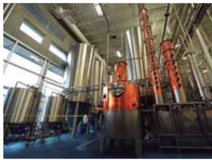
Las destilerías producen desde perfumes hasta bebidas alcohólicas usando el método de destilación.
